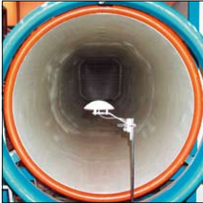
Prise statique placé dans le tunnel aérodynamique
